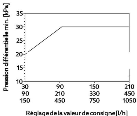
Pour les variantes DN 10 LF, DN 15 LF (les deux 30 à 210 l/h), DN 10 (90 à 450 l/h) et DN 15 (150 à 1050 l/h), la pression différentielle mesurée n'est pas identique à la pression différentielle réelle P1-P3.
