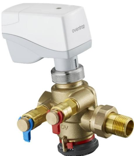
Vanne de contrôle indépendante de la pression pour l'équilibrage hydraulique dynamique d'échangeurs de chaleur, tels que ventilo-convecteurs ou plafonds rafraîchissants et pour conduites de distribution dans des installations de chauffage et de rafraîchissement à circuits fermés. La vanne Cocon qui est une combinaison d'un régulateur de débit à fonctionnement automatique et d'une vanne de réglage peut être équipée d'un moteur ou d'une poignée de réglage manuel. Montage sur l'aller ou le retour.
